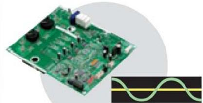
Úspory energie a vysoká účinnost při provozu díky sinusovému DC inverteru. Inverterové ztráty jsou omezeny díky nově použitému IPM a originálnímu řízení motoru.
