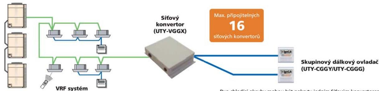
Dva chladicí okruhy mohou být pokryty jedním Síťovým konvertorem (UTY-VGGX). Až 16 Síťových konvertorů (UTY-VGGX) a adaptérů Systémového ovladače může být připojeno v jednom VRF systému.
