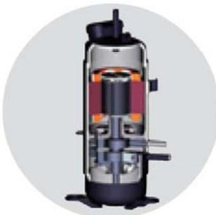
Vysoký výkon a nízká hlučnost díky DC dvojitému rotačnímu kompresoru. Každá část je optimalizovaná tak, aby se maximalizovala výkonnost komprese. Použitím dvojitého akumulátoru je dosaženo vysoké účinnosti provozu.
